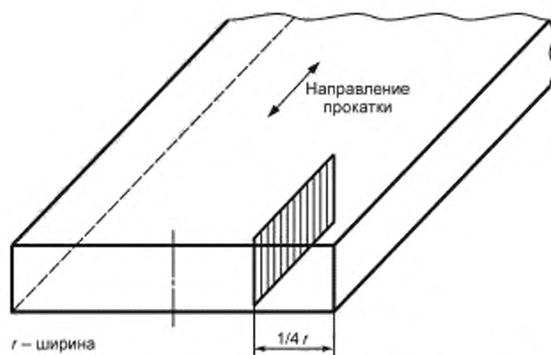
Рисунок 4 — Образец от листа толщиной не более 25 мм
